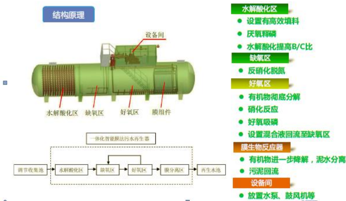
图 5-3 智能一体化膜法污水再生器工艺流程图
