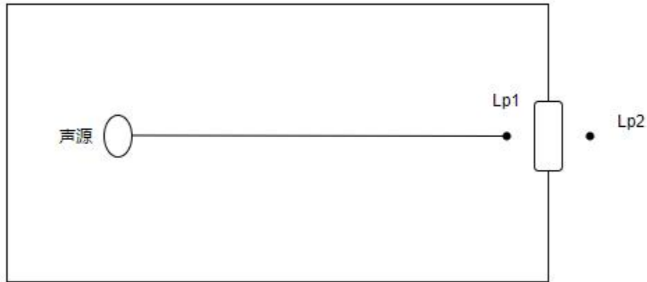
图4-1 室内声源等效为室外声源图例
