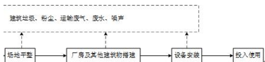
图 5-1 项目施工期工艺流程及产污环节图
