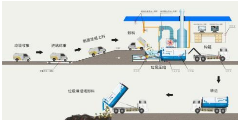
图 5-3 水平式压缩式垃圾转运操作示意图
