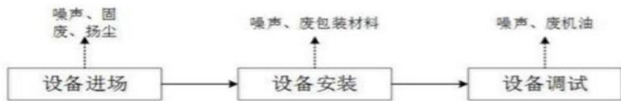
图 2-1 施工期工艺流程及产污环节
